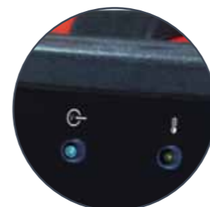
Индикация питания и термозащиты
