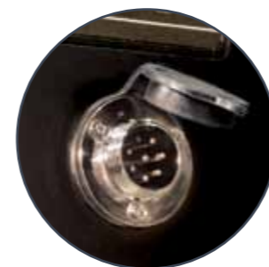
Разъем для подключения блока автоматики
