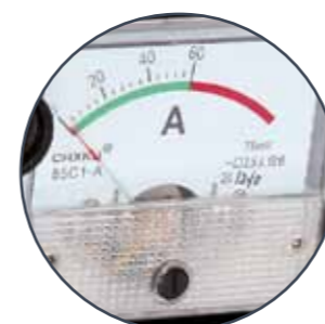
Индикатор зарядного тока (амперметр)
