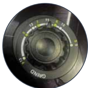
Настройка степени затемнения от 5 до 13 DIN
