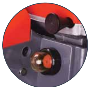
Система PRIMER – быстрый запуск непрогретого двигателя
